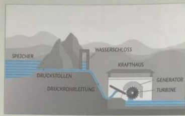
Bild 1: Speicherkraftwerk (schematischer Aufbau)
